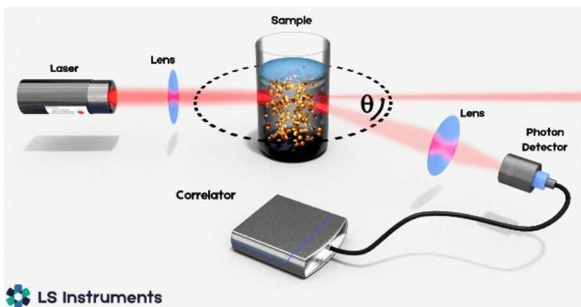
**Abbildung:** Aufbau und Funktionsweise der dynamischen Lichtstreuung: Laserlicht wird an Partikeln gestreut. Das gestreute Licht enthält Informationen über die Diffusion der Partikel und deren Radius.
